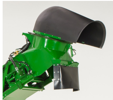
El extractor secundario completa la limpieza y con su giro de 360 grados dirige la materia extraña lejos del transporte, en la dirección deseada.
