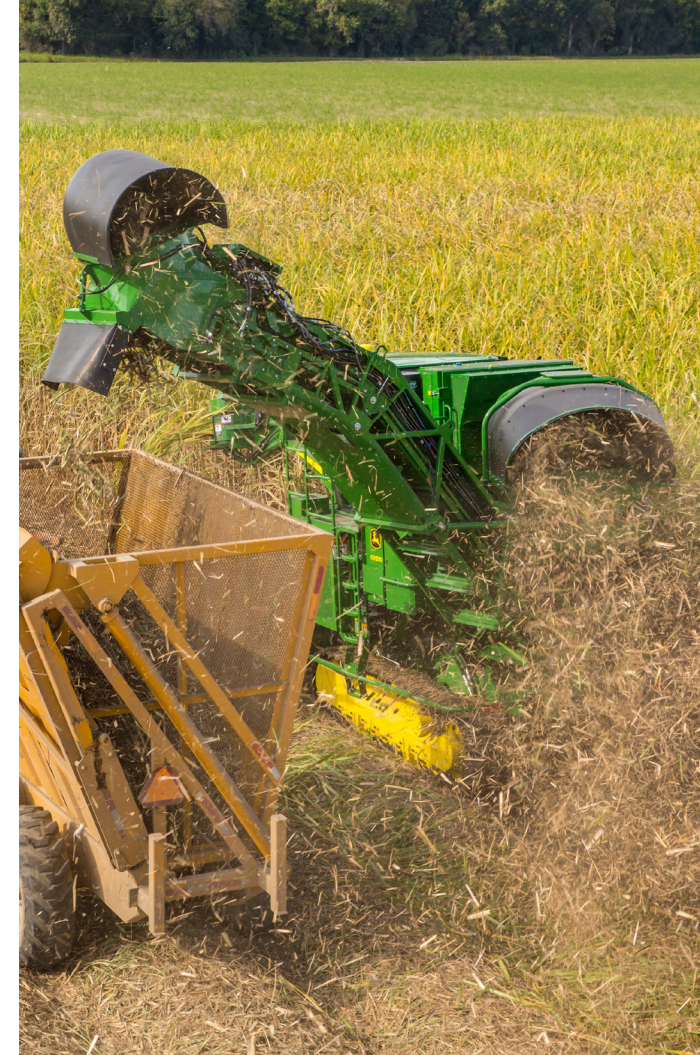
El extractor secundario completa la limpieza y con su giro de 360 grados dirige la materia extraña lejos del transporte, en la dirección deseada.
